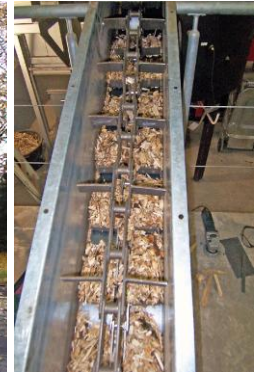
Blick in das Hackschnitzelvorratsgebäude Förderkette des Brennmaterials
